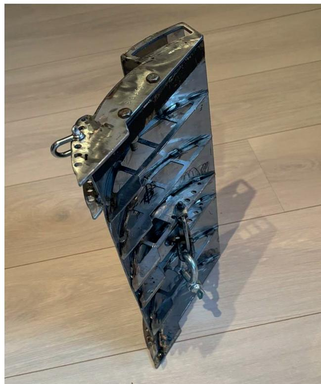
Рис. 1. Крыловидная траловая доска
