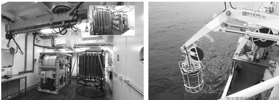
Рис. 3. Внутреннее устройство ангара на НИС VIRO INAPESCA (слева) и вид снаружи ЦЗР тип 1 на НИС Kagoshima Maru с СПУ типа кран-LARS (справа)
