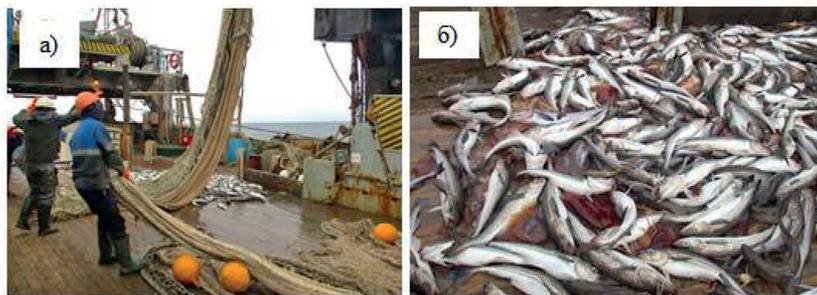
Рис. 3. Проведение траловой съёмки НИС «Профессор Леванидов» в юго-западной части Чукотского моря в августе 2019 г.: а — работа траловой бригады, б — улов минтая на палубе (около 1 т на получасовое траление)
