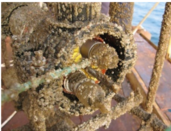
Рис. 1. Обрастание химических, оптических и акустических датчиков морской прибрежной станции
