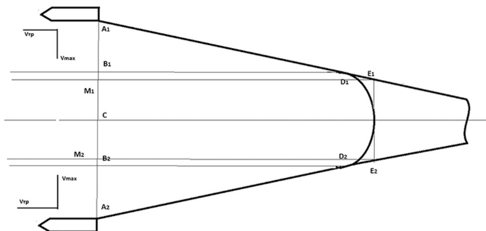
Рис. 5. Схема зон, влияющих на расстояние между судами-близнецами
